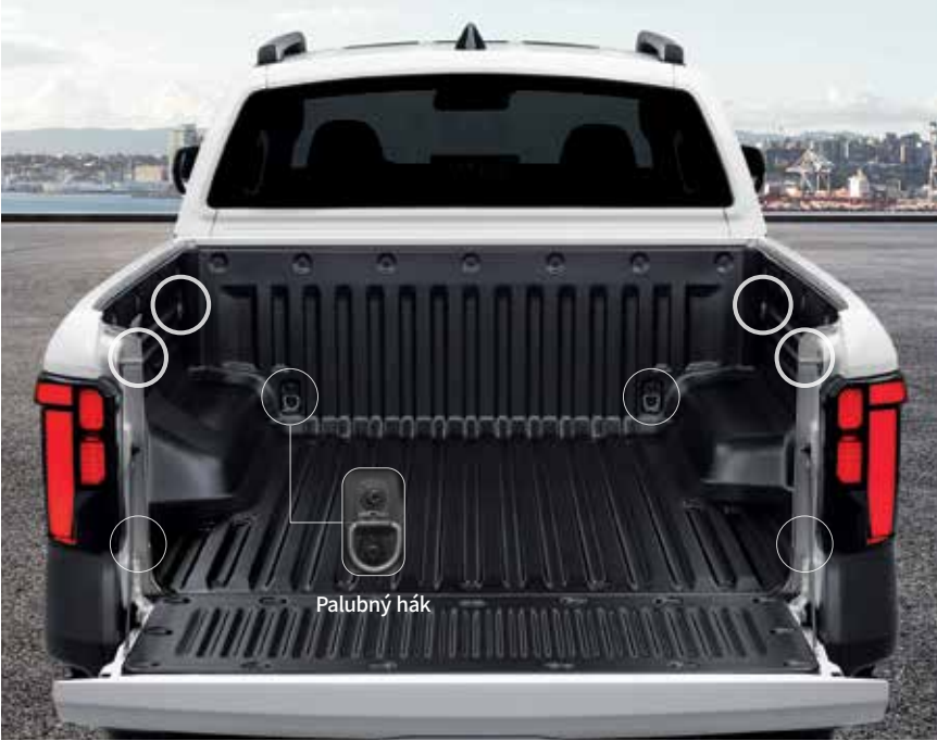
Palubný hák Zvýšenie počtu hákov zo štyroch na osem pre pevnejšie upevnenie rôznych nákladov a zvýšenie stability nákladu.
