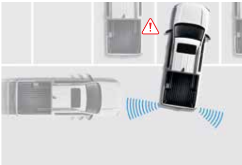
Upozornenie na detekciu mŕtveho uhla (BSW) / Asistent na sledovanie mŕtveho uhla (BSA) Systém BSW/BSA automaticky pomáha brzdiť, keď vodič zmení jazdný pruh a systém detekuje riziko kolízie s vozidlami v mŕtvom uhle.
