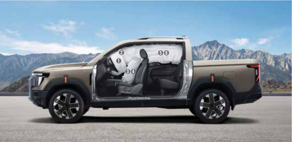
6 airbagov 1. Airbag vodiča 2. Airbag spolujazdca 3/4. Bočné airbagy vodiča a spolujazdca 5/6. Hlavové airbagy
