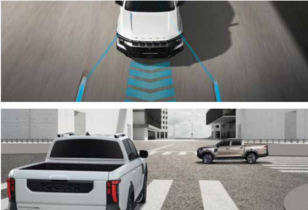
Upozornenie na vybočenie z jazdného pruhu (LDW) / Asistent udržiavania v jazdnom pruhu v strede vozidla (CLKA) Systém LDW/CLKA sleduje pomocou prednej kamery vyznačené dopravné značenie. Automaticky koriguje elektrický posilňovač riadenia tak, aby vozidlo zostalo v zamýšľanom jazdnom pruhu.
