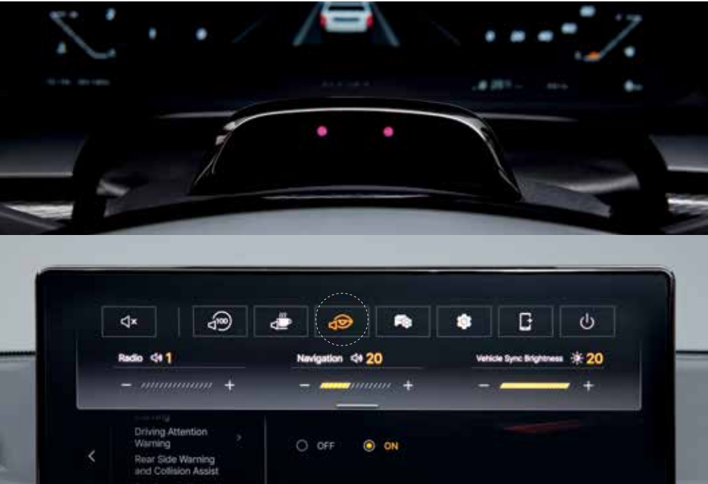
DMS (Systém sledovania vodiča) Aktivuje vizuálne a zvukové varovania, keď vodič počas jazdy detekuje nepretržitý pohľad pod volant alebo prístrojovú dosku.
